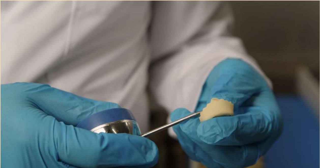
Operatore del Controllo Qualità monitora, con un data-logger, l'effetto pastorizzante in termini di tempo e temperatura.
